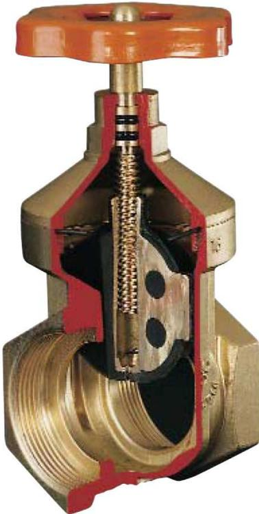
La válvula de compuerta es del tipo multivueeltas, en la cual se cierra el paso con un obturador vertical de caras planas, que se desliza en ángulo recto sobre los asientos. Este tipo de válvula se recomienda para servicios donde se necesita una apertura o cierre sin estrangulación (paso total), para uso poco frecuente y donde se necesita una resistencia mínima a la circulación.
